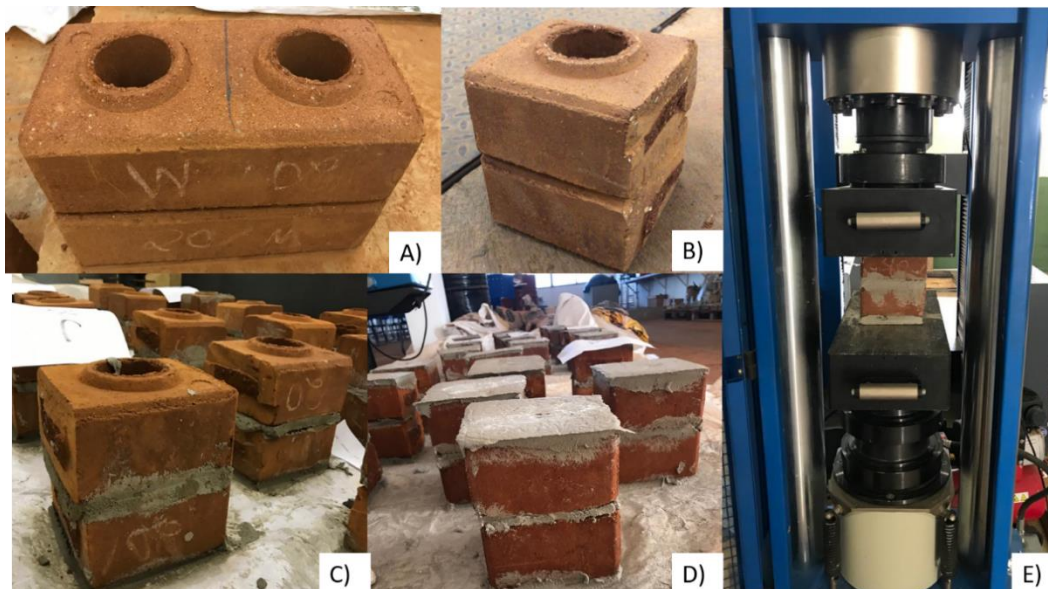
Figura 8: Ensaio de resistência à compressão mecânica: (a) e (b) tijolos preparados e serrados ao meio, (c) ligação das duas partes com pasta de cimento, (d) capeamento das duas faces e (e) rompimento dos tijolos.
