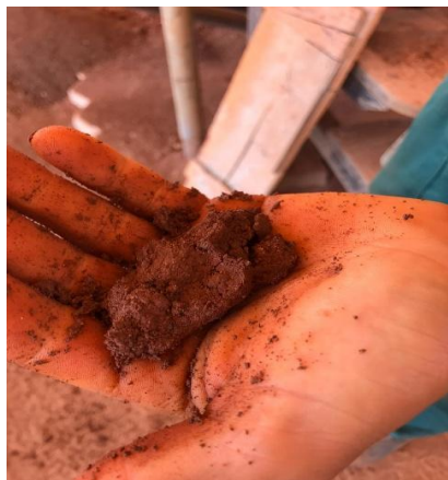
Figura 6: Teste empírico para determinação da umidade ótima do solo
