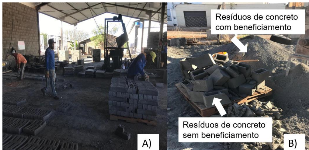
Figura 10: a) Empresa que fabrica artefatos de concreto e b) Resíduos de concreto sem e com beneficiamento
